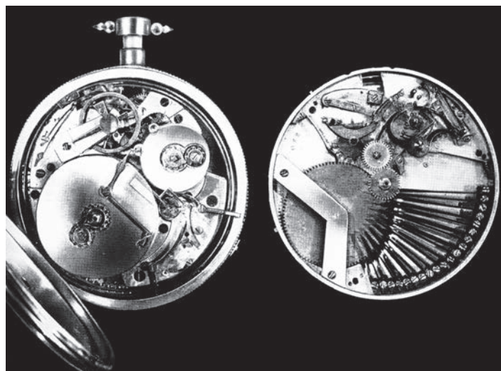
Kapesní hodinky s hracím strojkem, 19. století; převzato z knihy MICHAL, Stanislav. Hodiny. Praha: Státní nakladatelství technické literatury, 1980
